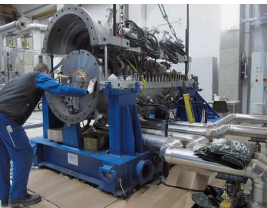
Vorbereitung von Experimenten am Magnetlagerversuchsstand
