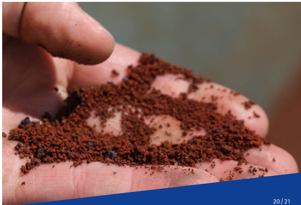
In der Handfläche die Klärschlammmasche nach der Verbrennung des Klärschlammes
